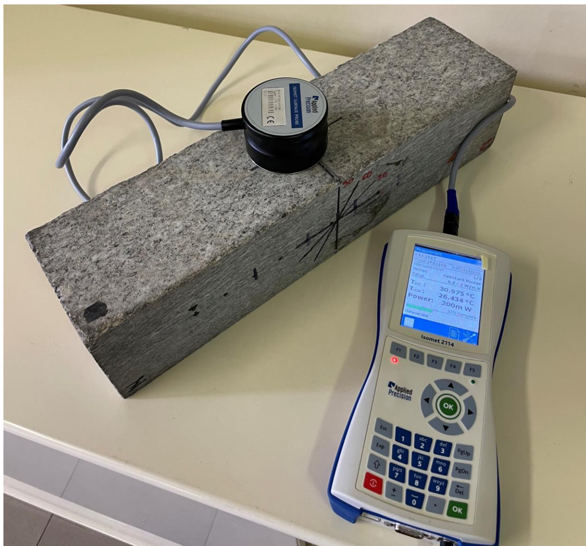
Figura 2.6 – Misurazione della conducibilità/capacità termica con la sonda plate probe Isomet 2114 in dotazione al Politecnico di Torino - DIATI.
