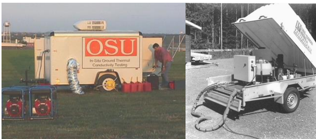
Figura 2.9 – I primi macchinari per l'effettuazione dei Thermal Response Test sviluppati dall'americano Spitler (a sinistra) e dalla svedese Gehlin (a destra). Fonte: Spitler e Gehlin, 2015 [33].
