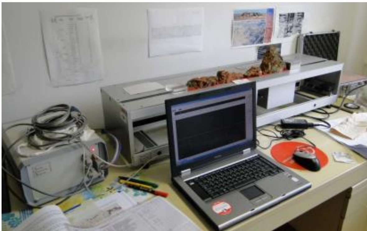
Figura 2.8 – Misurazione della conducibilità e della capacità termica di un campione di roccia con un Thermal Conductivity Scanner (TCS). Fonte: progetto GRETA – Alpine Space [32].
